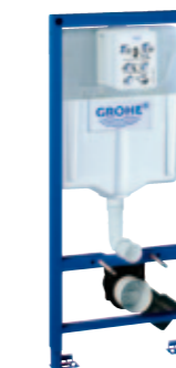
38 528 001 Rapid SL für WC mit Spülkasten GD2 Start/Stop oder 2-Mengen (6 l / 3 l) Vorwand oder Ständerwandmontage Bauhöhe 1,13 m
